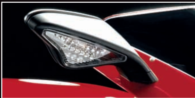
L'illuminazione degli indicatori di direzione, integrati negli specchietti retrovisori, sfrutta la tecnologia LED più avanzata. / Directional indicators illuminated by the latest LED technology are integrated into the rear view mirrors.
