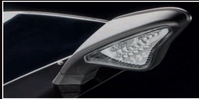
Gli specchietti retrovisori della 1198 e 1198 S vengono forniti con kit distanziatore per consentire un allungamento optional di 30mm dello stelo. / 1198 and 1198 S mirrors come with a spacer kit, enabling an optional 30mm stem length extension.
