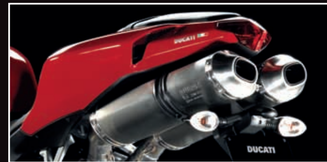
Doppi scarichi sotto-sella in acciaio inox completano il leggerissimo impianto 2-1-2. / Twin under-seat exhausts in stainless steel terminate the 2-1-2 lightweight system.
