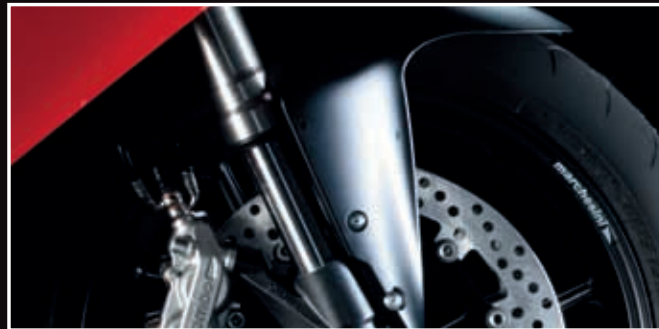
Forcella Showa da 43mm completamente regolabile. / Fully adjustable 43mm Showa forks.
