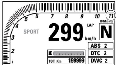
慣らし運転期間が終了すると、"オレンジゾーン"はエンジンが十分温まっていない状態でエンジン回転数を抑える指示として表示されます。"オレンジゾーン"は以下の通り、エンジン温度によって異なります。
