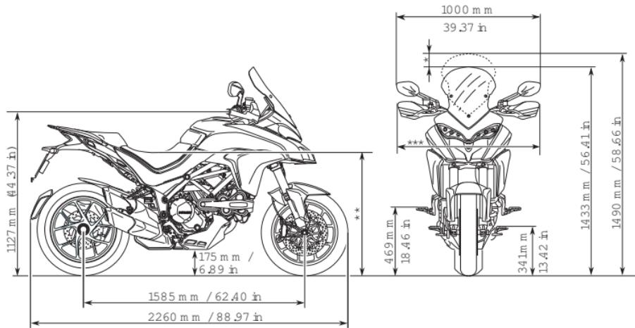
\* 1,433 mm (56.41 in) (ヘッドライトフェアリング最下段)、1,447 mm (56.97 in) (ヘッドライトフェアリング一段目)、1,461 mm (57.52 in) (ヘッドライトフェアリング二段目)、1,476 mm (58.11 in) (ヘッドライトフェアリング三段目)、1,490 mm (58.66 in) (ヘッドライトフェアリング最上段)
