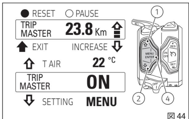
Trip Master機能を停止するには、ボタン(1)および(2)でメニュー内をスクロールし、"TRIP MASTER ON"を選択してボタン(4)を押します。これによって、インストルメントパネルが機能を中止し、カウントをリセットします。
