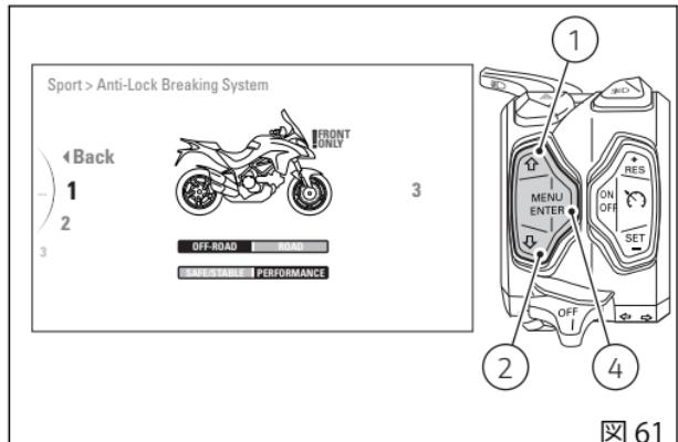
ボタン(1)と(2)を使用して、設定したい介入レベルを選択します。レベルを強調すると、そのレベルに運動する値が中央の表に表示されます(黒色背景)。さらに、ブレーキシステムの介入レベルが青色で表示され、フロントブレーキだけがONの時は“**IFRONT ONLY**”(図61)の文字、コーナリング機能がONの時は“**CORNERING**”(図62)の文字が表示されます。
