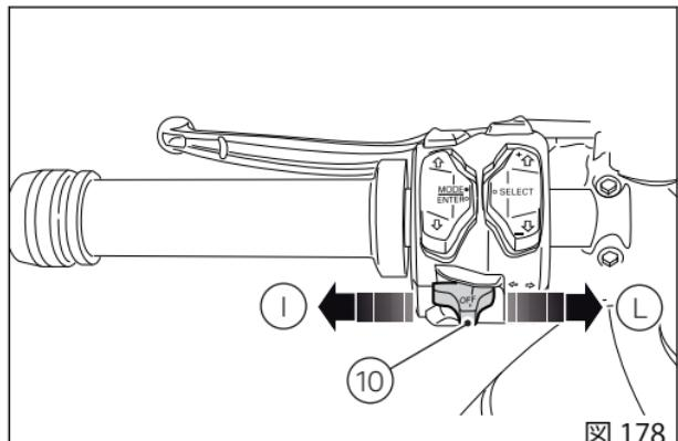
自動解除システムは設定メニュー(SETTING MENU)の専用メニューから停止することができます。詳しくは「ターンインジケーター自動解除の操作」(TURN INDICATORS)の章をご覧くださいページ 181。
