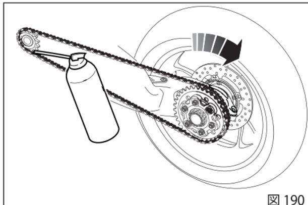
チェーン内部のリンクの内側と外側に、スプロケットとのかみ合わせの直前の箇所 (2) で、潤滑剤 (1) のジェットを噴射します。
