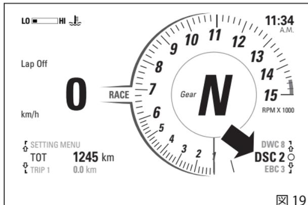
DSC は 2 通りのレベルで動作します。各レベルは DTC の特定レベルと組み合わせてタイヤの横滑りに介入する異なる値が設定されています。
