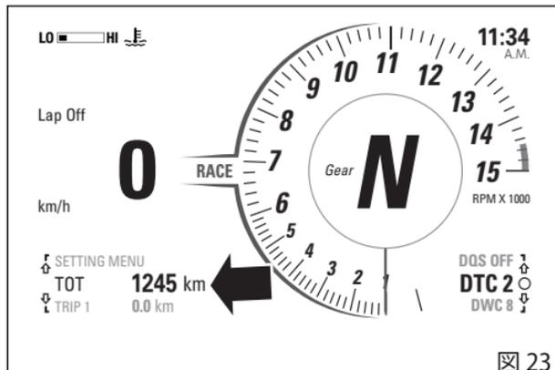
各種機能がスクロール表示できる時は、メニューの左側にUP ↑ およびDOWN ↓ 矢印が現れます。矢印はブラウズボタンに相当します。丸印 ○ の表示は、ENTER ボタンを押して表示された機能进行操作できることを示します。例えばトリップメーターTRIP 1のリセットです。
