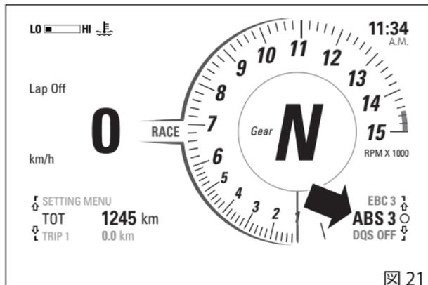
検知すると、ブレーキ回路内の油圧を制御します。この場合には、ブレーキ回路内の油圧を低下させることでホイールを回転させ続け、路面とのグリップを最適に維持します。
