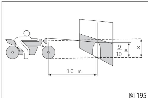
ヘッドランプの光軸調整を行うには、車両前部、左右に設けられたスクリュー (1) または (2) を回します。
