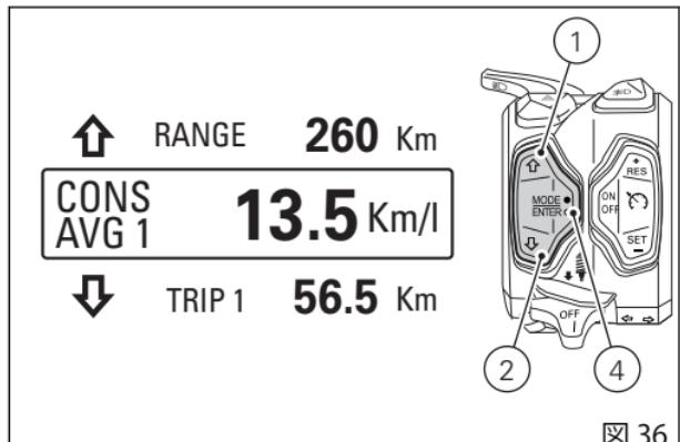
平均燃費がリセットされると、数値が表示されない最初の 10 秒間は 3 本の破線“---”が表示されます。
