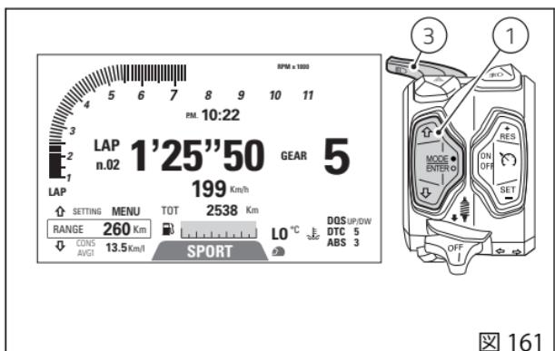
ラップタイムの "ストップ" 指示が出されなかった場合、7分59秒99の時点でストップウォッチはゼロに戻り、ストップ指示が出されるまでラップタイムを測定し続けます。
