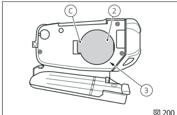
裏側のプラスチックカバー(1)を図のように軽く押しながら取り付けます。
