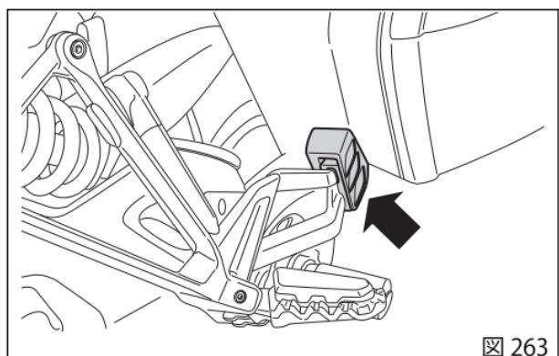
取り付け位置の奥までバッグを押し込みます(フロントホイールに向かって押します)。バッグがこの位置にあるときしか、バッグのハンドルを倒して取り付け位置に固定することはできません。これによりバッグがロック位置に確実に固定されます。
