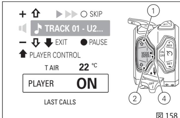
プレーヤーメニューから出た後にプレーヤーを停止するには、ボタン(4)を押します。インストルメントパネルは"PLAYER OFF"の文字を表示します(図 156)。
