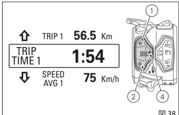
一方ボタン (4) を押した場合は、TRIP TIME 1 のデータがリセットされます。インストルメントパネルは TRIP TRIP 1 の表示に戻り、“0:00” を表示します。
