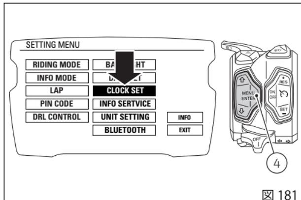
メニューに入ると、左側に調整が可能な内容、AM / PM、HOUR、MINUTES が表示され、右側には設定されている時間が表示されます (例：AM 10:30)。
