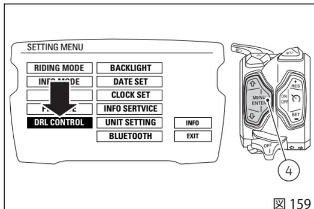
この機能に入ると、左側に DRL の設定： AUTO、MANUAL が表示されます。一方、右側("EXIT"の上)には現在設定されているモードが表示されています。ボタン(1)および(2)を押すと希望の DRL ステータスタイプを一つずつ強調表示することができます。ボタン(2)を押すと次のパラメーターが、ボタン(1)を押すと前のパラメーターが強調表示されます。希望のタイプを選択したら、ボタン(4)を押して決定します。インストルメントパネルはユーザーが選択したモードを ON にし、該当する文字が強調表示されます。AUTO タイプを選択すると、DRL、ハイビームライト、ロービームライトは外光の明るさに応じて昼間モードと夜間モードの間で自動的に切り替わります。メニューを終了して前の画面に戻るには、"EXIT"の文字を強調表示し、ボタン(4)を押します。
