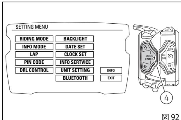
点検終了時に KEY-ON した時キーが認識されなかった場合、PIN CODE が有効になっていればロック解除コード PIN CODE を入力する画面が表示されます。ボタン(1)およびボタン(2)を使用してコードの各桁を入力し、(4)を押して決定します。
