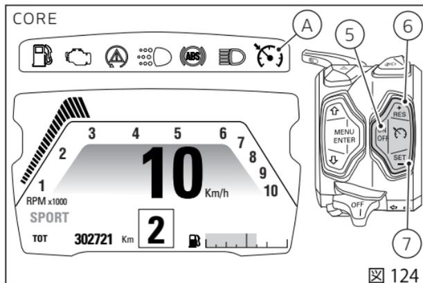
一旦システムを起動すると、SET ボタン (7) を押して現在の走行速度を設定速度として設定することができます。以前に一度も設定速度を設定していない場合、SET ボタン (7) の代わりに RES ボタン (6) を押しても現在の走行速度を設定速度に設定することができます。この場合、システムは現在の走行速度を記録すると、スロットルを操作することなく記録した速度が維持されます。
