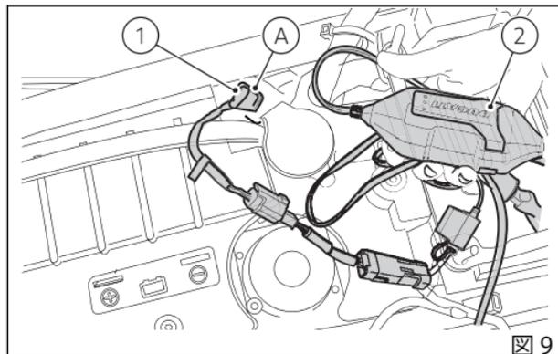
車両を使用しない期間 (およそ 30 日以上)、Ducati バッテリーメンテナー (バッテリーメンテナーキット) の使用をお勧めします。電力をモニターする内部エレクトロニクスが搭載されており、充電電流は最大 1.5 A/h です。バッテリーメンテナーを診断ソケットに接続します。
