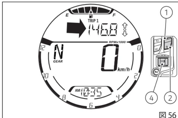
インストルメントパネルにはKey-OFF時に使用していたメニューの設定が記憶されます。次にKey-ONした時、インストルメントパネルのメニューに10秒間"オドメーター"機能が表示され、その後前回のKey-OFF時に保存した機能が表示されます。この最初の10秒間にボタン(1)またはボタン(2)を押すと、オドメーター(TOT)の10秒間の強制表示が中止され、前回のKey-OFF時に保存した機能が表示されません。
