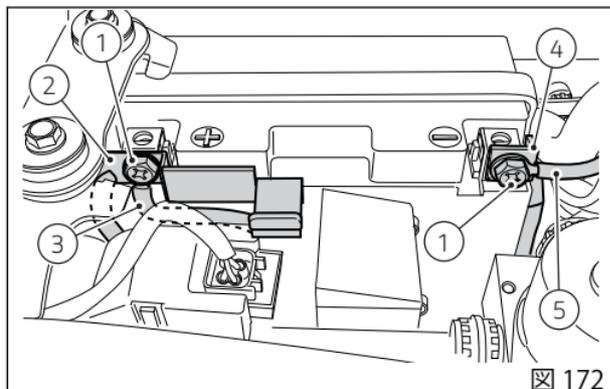
マイナスケーブル(4)およびABSマイナスケーブル(5)をバッテリーのマイナス端子に接続します。接続は必ずプラス側(+)から始め、スクリュー(1)を差し込みます。
