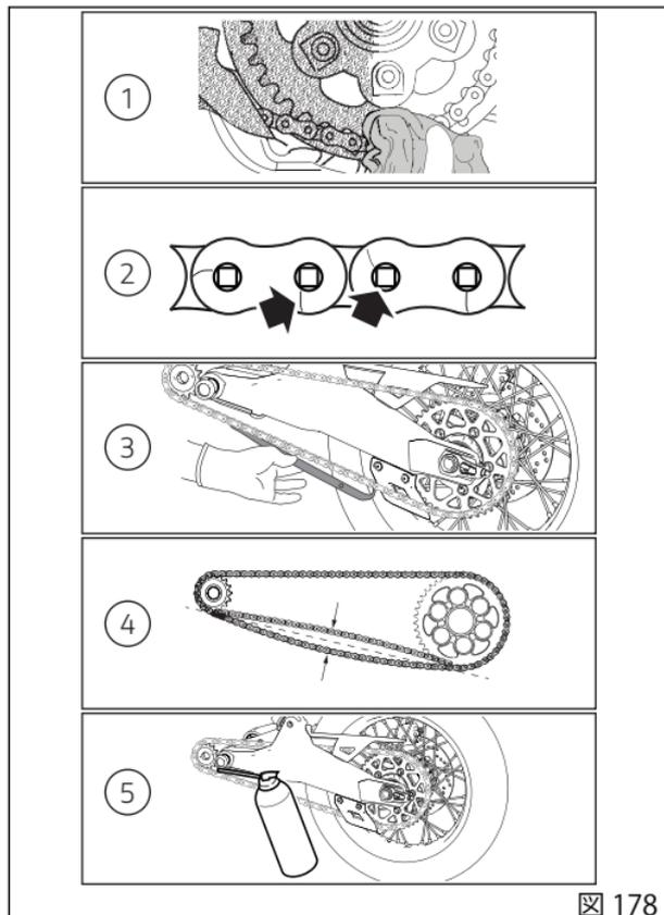
指定箇所 (2) のリンクを点検して、チェーンの摩耗状態を確認します。
