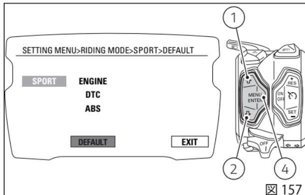
パラメーターの回復には3秒を要し、この間 "WAIT...." の文字がディスプレイに表示されます。手順が終了すると、ディスプレイに2秒間 "OK" の文字が表示され、パラメーターが回復されたことを示します。"EXIT" の文字が強調表示されます。メニューを終了して前の画面に戻るには、"EXIT" の文字を強調表示し、ボタン (4) を押します。
