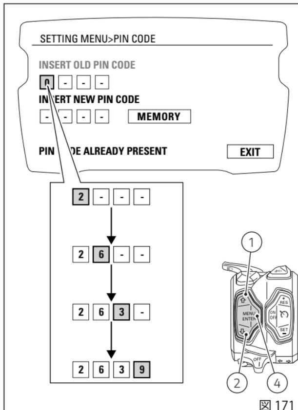
"INSERT NEW PIN CODE" と一桁目が緑色に強調された点線 "----" が表示されます。新しい PIN CODE を入力してください。
