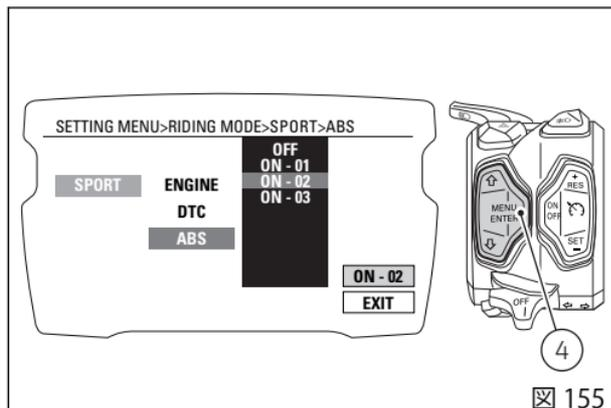
この機能に入ると、右側("EXIT"の上)に現在設定されているABSレベル、または状態が表示されます(例：ON-03、すなわちレベル03)。
