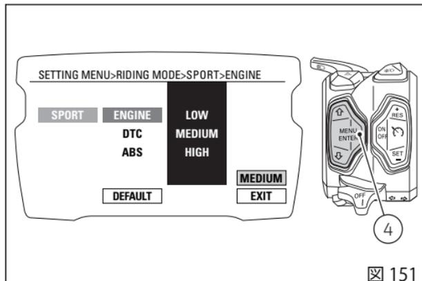
この機能に入ると、右側("EXIT"の上)に現在設定されているエンジン出力が表示されます(例：MEDIUM)。中央のプルダウンメニューにはパーソナライズ可能な一覧が表示されます。
