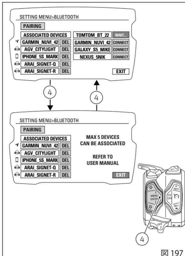
ペアリングするデバイスを選択すると、選択したデバイスに該当するラベルが "CONNECTED" から "WAIT" に代わり、ペアリングしたいデバイスのタイプを選択する必要があります。選択可能なデバイスタイプに相当する4つのアイコンが表示されます。
