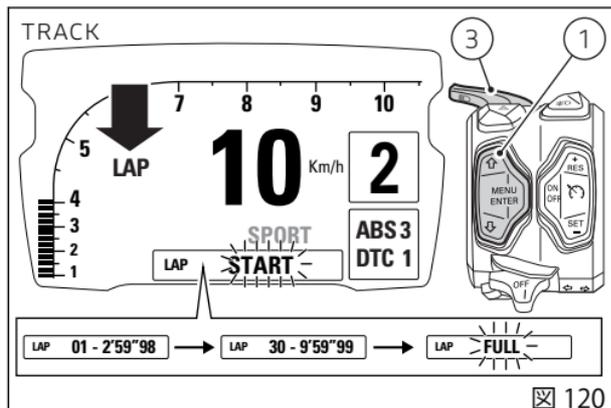
LAP機能がメニューで選択したものと異なる場合、表示完了時インストルメントパネルはFLASHボタン(3)を押す前の機能を表示します。
