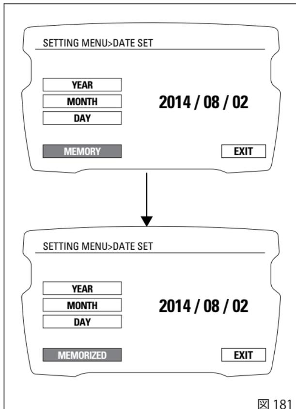
日付が正しくない場合、インストルメントパネルは "WRONG DATE" を 3 秒間点滅表示した後、日付に点線 "----/--/--" を表示して自動的に "EXIT" の文字を強調表示します。この場合も新しく別の日付を設定することができます。
