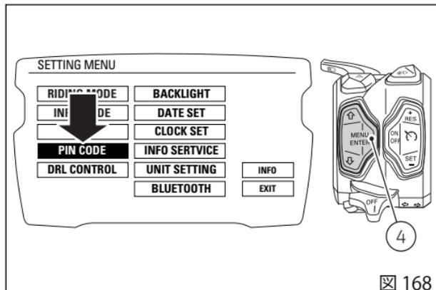
この機能に入ると、ディスプレイに "INSERT NEW PIN CODE" の文字、その下に一桁目が緑色に強調された点線 "0---" が表示されます。
