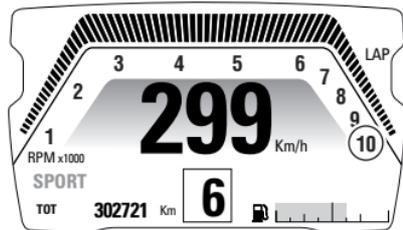
CORE 表示モードのエンジン回転数表示はTRACKおよびFULL 表示モードのエンジン回転数表示とは異なります。
