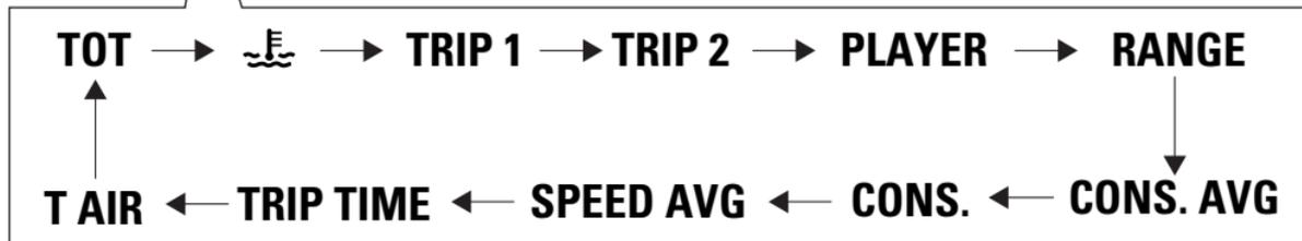
表示モード FULL では、インストルメントパネルに KEY-OFF 時に使用していたメニュー 1 とメニュー 2 の設定が記憶されます。次の KEY-ON 時、前回記憶したメニュー 1 およびメニュー 2 のページが表示されます。急な KEY-OFF (電源供給が突然途絶えた) の場合は、次の KEY-ON 時にインストルメントパネルには次のメニュー 1 とメニュー 2 のデフォルト設定が表示されます。
