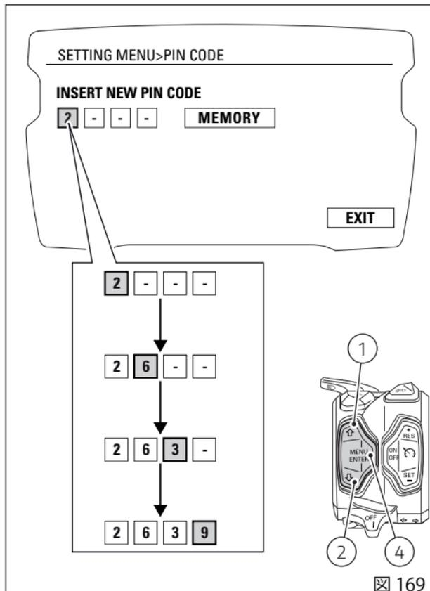
ボタン (4) を押して最後の桁を決定すると、"MEMORY" の文字が強調表示されます。新しい設定を保存するには、"MEMORY" の文字がオレンジ色に強調表示された状態でボタン (4) を 2 秒間押します。保存が正しく完了すると、"MEMORIZED" の文字が 1 秒間緑色に強調され、その後 "EXIT" の文字が緑色で強調表示されます。最初の PIN CODE を設定して以降は、メニューから PIN CODE 登録ページに入ることができなくなり、代わりに PIN CODE の変更のページになります。PIN CODE 機能がリセットされた場合に限り、最初の PIN CODE の登録ページが有効になり、メニューから入ることができるようになります。リセットはDucati正規サービスセンターでのみ実施が可能です。
