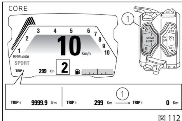
TRIP1 のカウントは、システムの単位を手動で変更した場合とバッテリー OFF の後にも自動的にリセットされ、新しく設定した単位でゼロから再びカウントを始めます。
