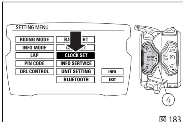
メニューに入ると、左側に調整が可能な内容、AM / PM、HOURS、MINUTES が表示され、右側には設定されている時間が表示されます (例：AM 10:30)。
