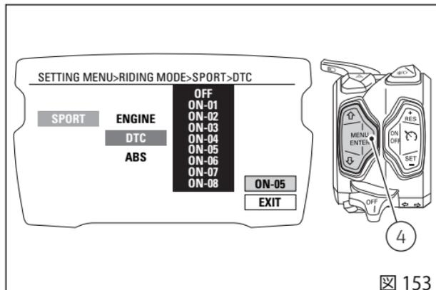
この機能に入ると、右側("EXIT"の上)に現在設定されている DTC レベル、または状態が表示されます (例：ON - 05、すなわちレベル 05)。
